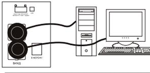
Не підключайте лазерний принтер, чи інше обладнання з двигунами до розетки ДБЖ.
